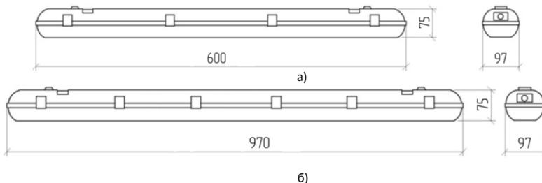
Рисунок 1 – Габаритные размеры светильника ЛСП 600, ЛСП 900.
